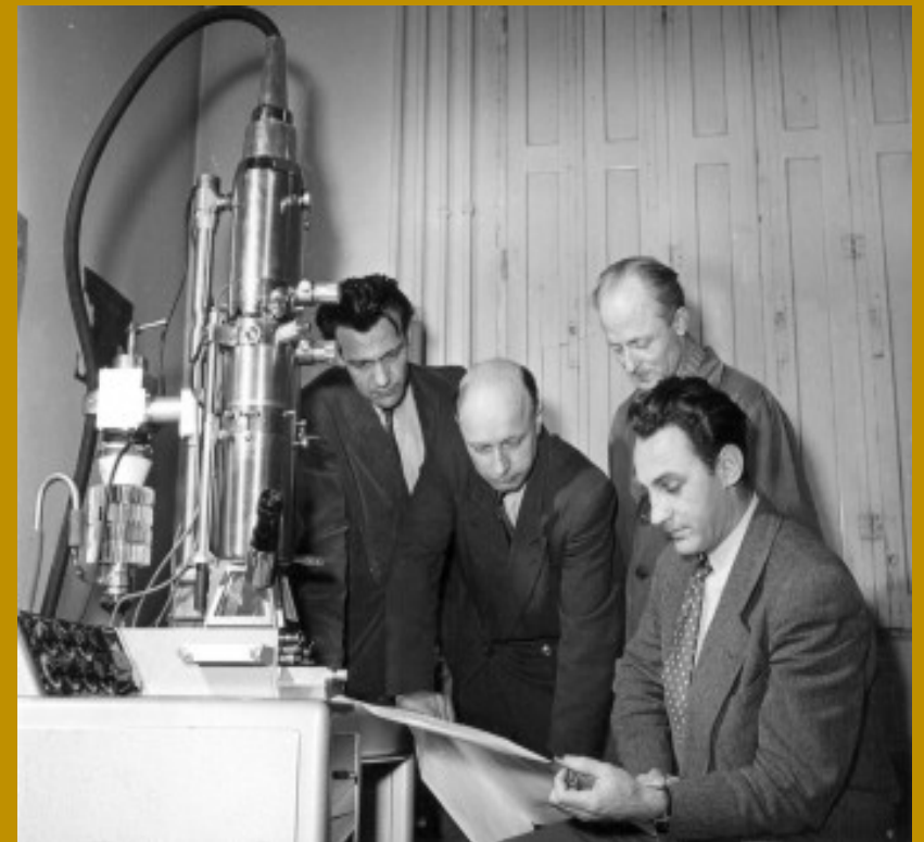
Experimentální prozařovací elektronový mikroskop – 100 kV (L. Zobač, V. Drahoš, J. Speciální a sedící A. Delong) 1954
