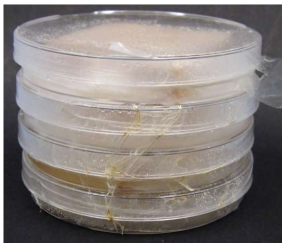
Obr. 3. Kultury dřevomorky domácí ( Serpula lacrymans ) v Petriho miskách, kultivované na dřevěných špalíčkách, uložených v agarovém loži. Viditelné jsou rhizomorfy, opouštějící misky a hledající zdroj vlhkosti a živin jinde.
