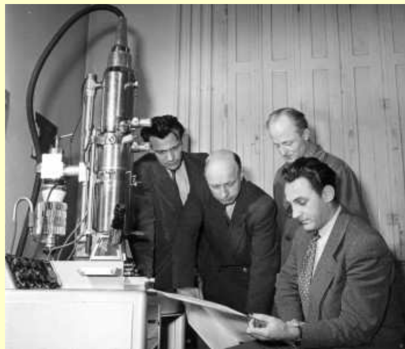
Experimentální prozařovací elektronový mikroskop – 100 kV (L. Zobač, V. Drahoš, J. Speciální a sedící A. Delong) 1954
