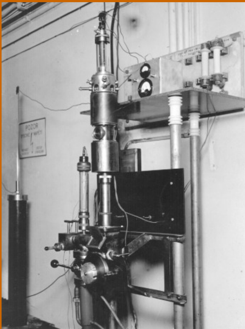
Experimentální prozařovací elektronový mikroskop – 100 kV (L. Zobač, V. Drahoš, J. Speciální a sedící A. Delong) 1954
