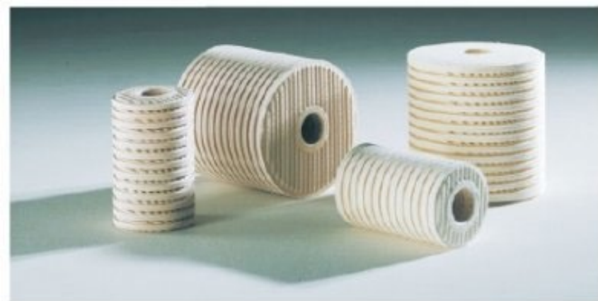
Filtrační vložky CJC řady B a BLA velikosti 15/25 a 27/27 pro CJC OFF-LINE obtokovou filtraci lubrikačních, hydraulických, turbínových, převodových, honovacích a válcovacích olejů
