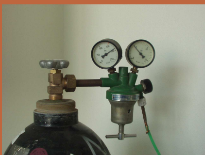
3. Jehlovým ventilem se nastaví požadovaný tlak na výstupu a uvolní se vypouštěcí ventil.
