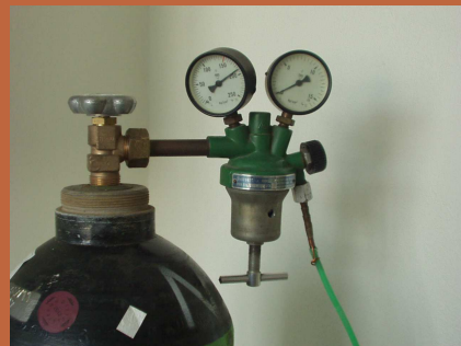
2. Hlavní ventil (na bombě) je otevřený, jehlový vytočen dolů, vypouštěcí je zavřený.
