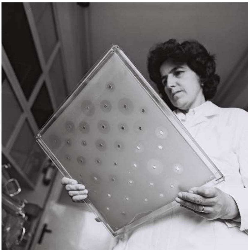
Obr. 33. Dr. Marta Semerdžieva (MBÚ ČSAV) při plotnových testech na AB účinnost nových látek. V desce (60x60 cm) po zaočkování (má dvě vrstvy agaru; spodní je 3%, tzv. základ, horní 1,5%) do horní vrstvy ještě tekutého agaru se do druhého dne vytvoří čiré zóny, z jejichž průměru lze vypočítat MIC. Testovaná látka se pipetuje ve stejném množství v různých koncentracích do otvorů, vyrobených korkovrtem. B. subtilis nevdí, E. coli ohavně smrdí.
