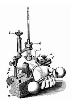
Fig. 2a. Von Basch's sphygmomanometer [11].
